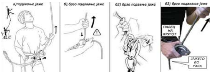
Слика 10: Гри гри – подавање јаже при качување.
